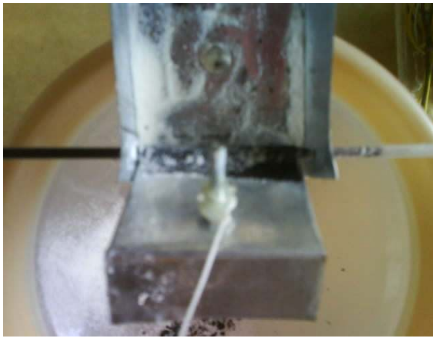
Bak penimbangan dan lubang tempat pemasangan strain gauge
