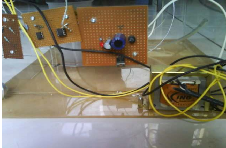
Rangkaian jembatan, rangkaian Op-Amp, dan rangkaian power supply
