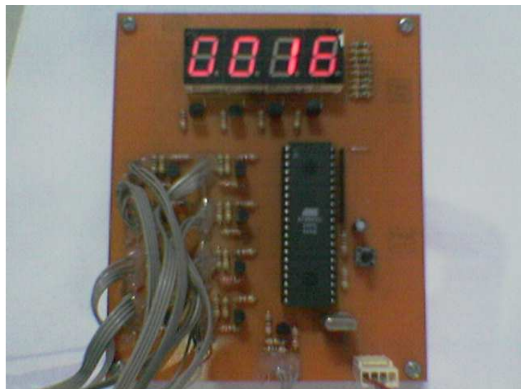
Gambar 8 Tampilan saat kartu penumpang 2 dimasukkan ke rangkaian turun dengan jarak tempuh 4 kedipan (2 meter)
