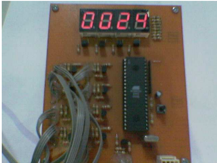
Gambar 9 Tampilan saat kartu penumpang 3 dimasukkan ke rangkaian turun dengan jarak tempuh 6 kedipan (3 meter)
