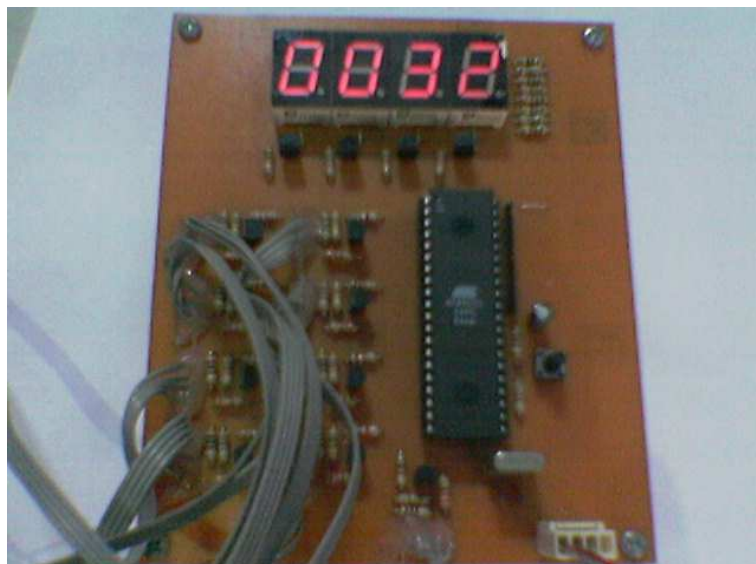
Gambar 10 Tampilan saat kartu penumpang 4 dimasukkan ke rangkaian turun dengan jarak tempuh 8 kedipan (4 meter)
