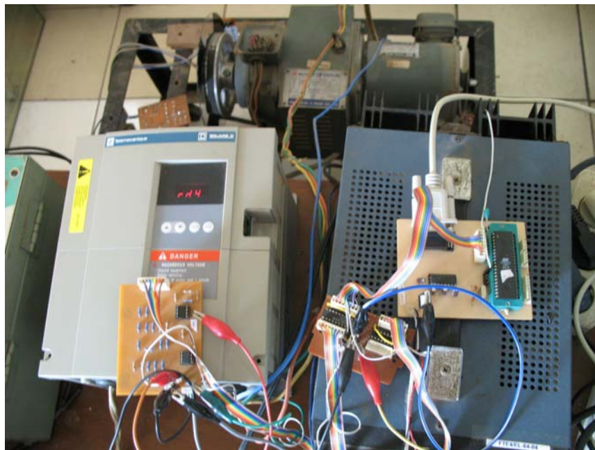
Foto2: Perangkat keras MCS-51, DAC, dan inverter.
