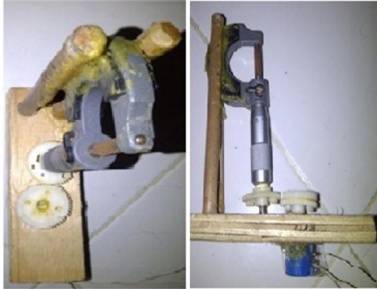
**Gambar E.4 Mikrometer Sekrup yang dihubungkan dengan wirewound menggunakan roda gigi**
