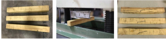
(a) Benda uji lentur (b) Pengujian lentur (c) Ragam kegagalan Gambar 3. Benda uji, pengujian, dan ragam kegagalan benda uji lentur [1]
