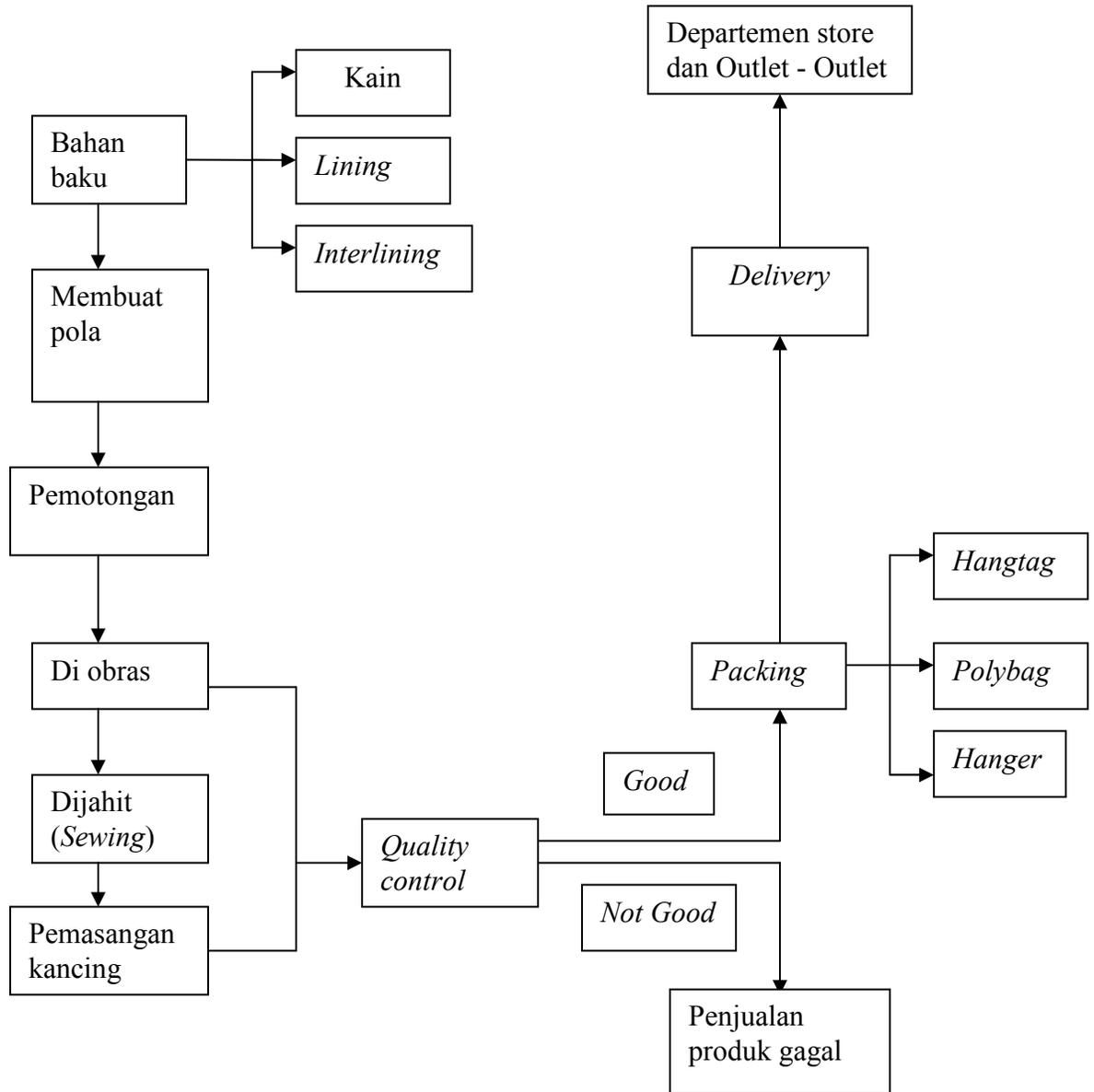
Skema Proses Produksi PT. Multi Mode Mandiri Three-M
