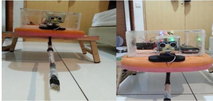
Gambar 6 Sensor Ultrasonik Membaca Jarak Depan dan Sensor Sentuh
