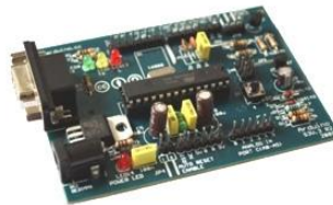
Gambar 2 Arduino Duemilanove dengan ATmega328 Sumber: arduino.cc
