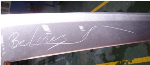
Cacat belang yaitu cacat yang terjadi karena catnya tidak rata, sehingga mengakibatkan hasil pengecatan tidak merata.
