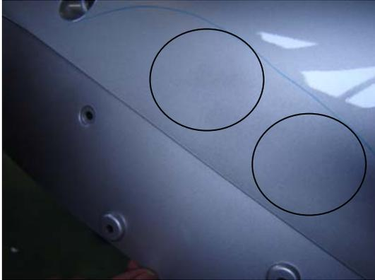
Cacat menyerap adalah cacat yang terjadi karena kondisi *raw material* yang tidak baik, yang mengakibatkan hasil pengecatan terlihat seperti menyerap kedalam benda kerja.
