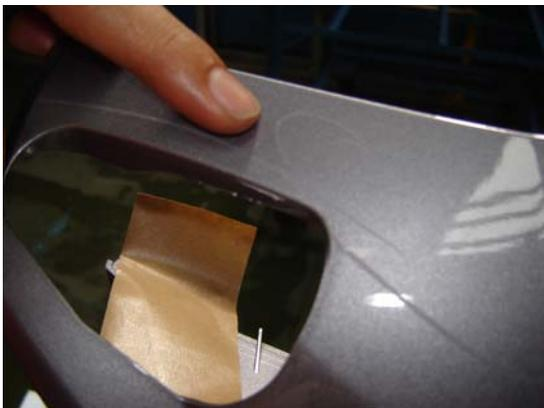
Cacat bintik kotor adalah cacat yang terjadi karena masuknya partikel debu pada saat proses pengecatan.
