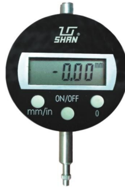
Gambar 1.1 Dial indicator untuk mengukur bukaan katup
