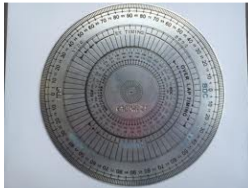
Gambar 1.2 Busur derajat cam untuk mengukur kemiringan camshaft
