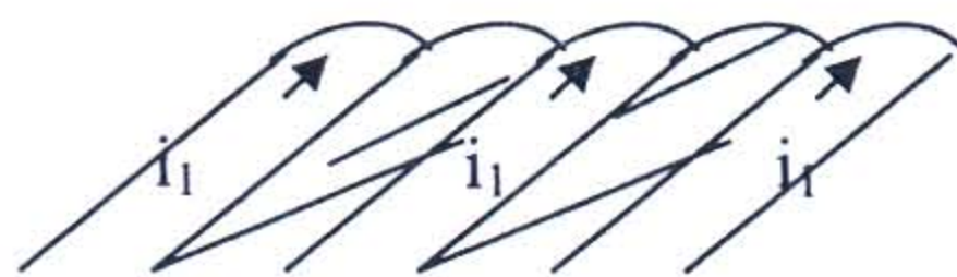
Gambar 4. Skema kumparan yang dipuntir
