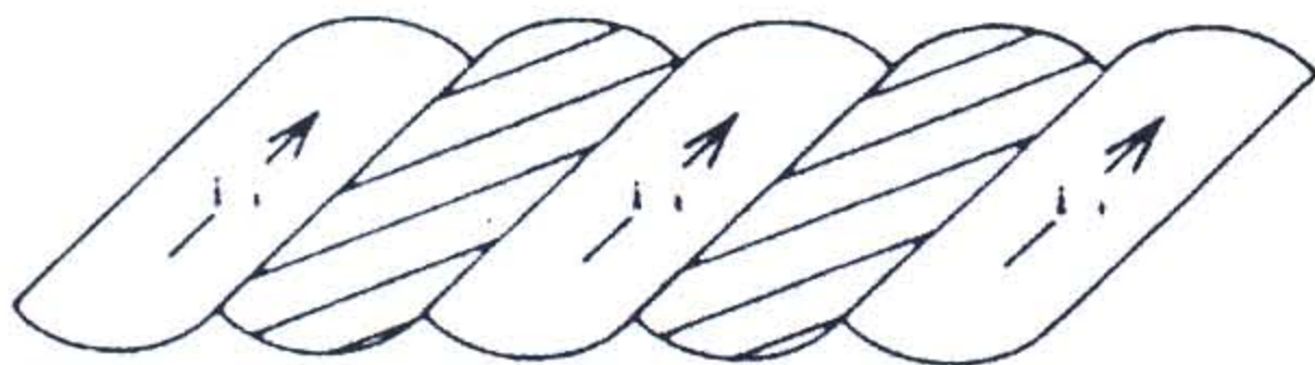
Gambar 4 : Beberapa konduktor yang di twisted menjadi kumparan
