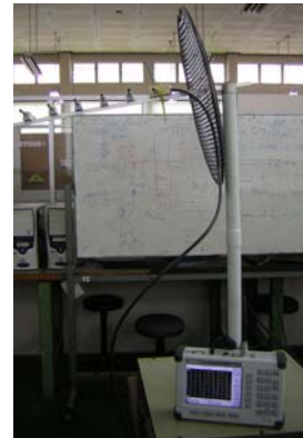
Foto Set-up Pengukuran VSWR
