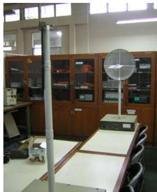
Foto Set-up Pengukuran Gain dan Pola Radiasi
