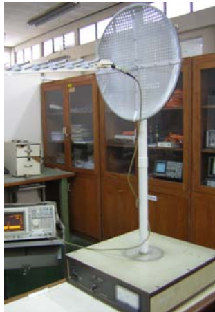
Foto Set-up Antena Penerima
