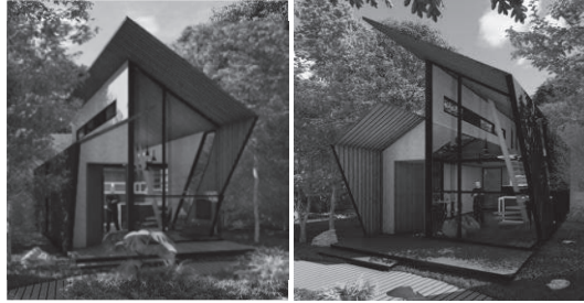
Gambar 3 Gagasan pengolahan bentuk atap dan lebar teritisan yang disesuaikan dengan posisi dan orientasi bangunan terhadap arah datang sinar matahari (Radjendra, 2024)
