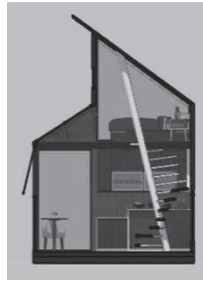
Gambar 1 Atap miring dan tinggi memberikan ruang udara besar dan mempercepat gerak udara (Radjendra, 2024)
