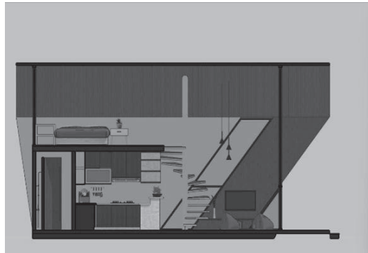
Gambar 2 Lebar teritisan yang disesuaikan untuk memberikan pembayangan yang dibutuhkan bangunan (Radjendra, 2024)
