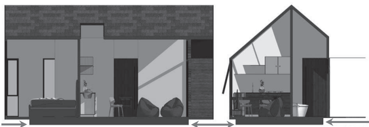
Gambar 4 Gagasan sistem panggung pada model hunian (Saragih, 2024)
