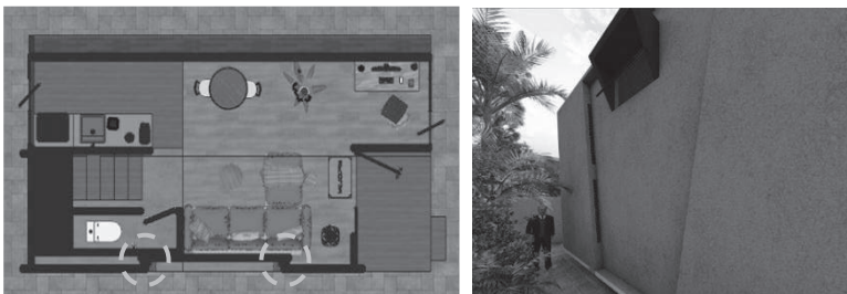
Gambar 8 Pengaturan posisi dinding yang memiliki celah sehingga memungkinkan pertukaran udara (Chandra, 2024)
