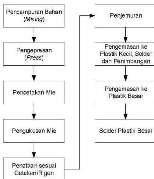
Gambar 4. Urutan proses pembuatan mie Cap Tiga Anak
