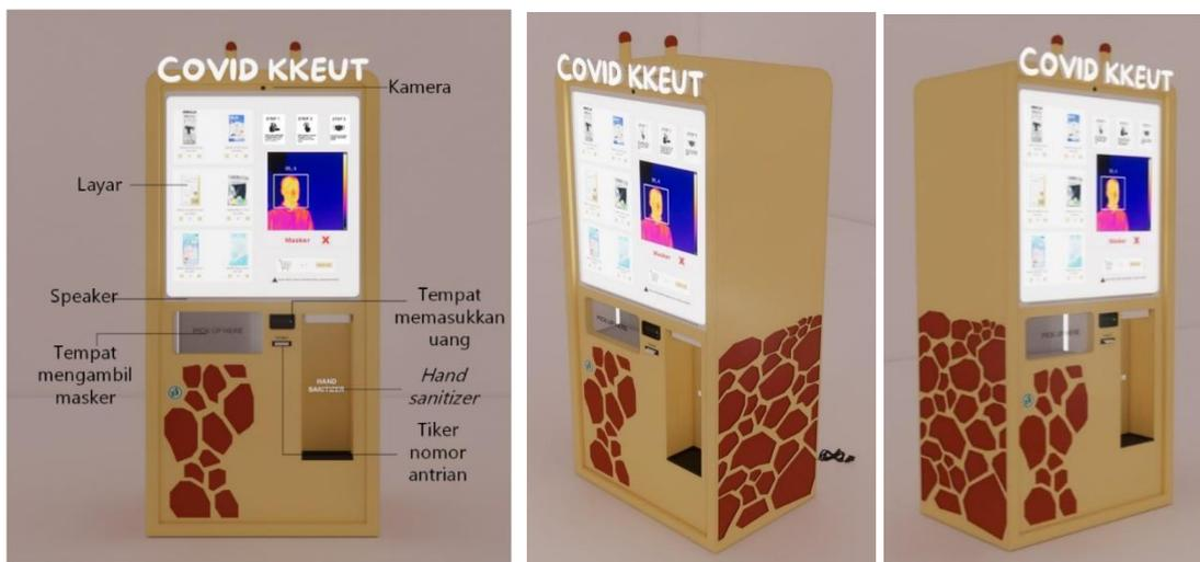
Gambar 8. Keterangan mesin
