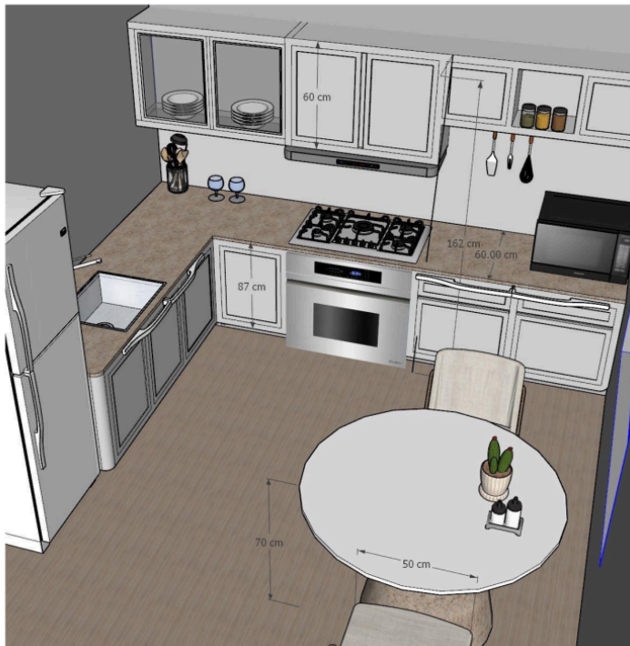
Gambar 2. Desain kabinet berdasarkan data antropometri lansia
