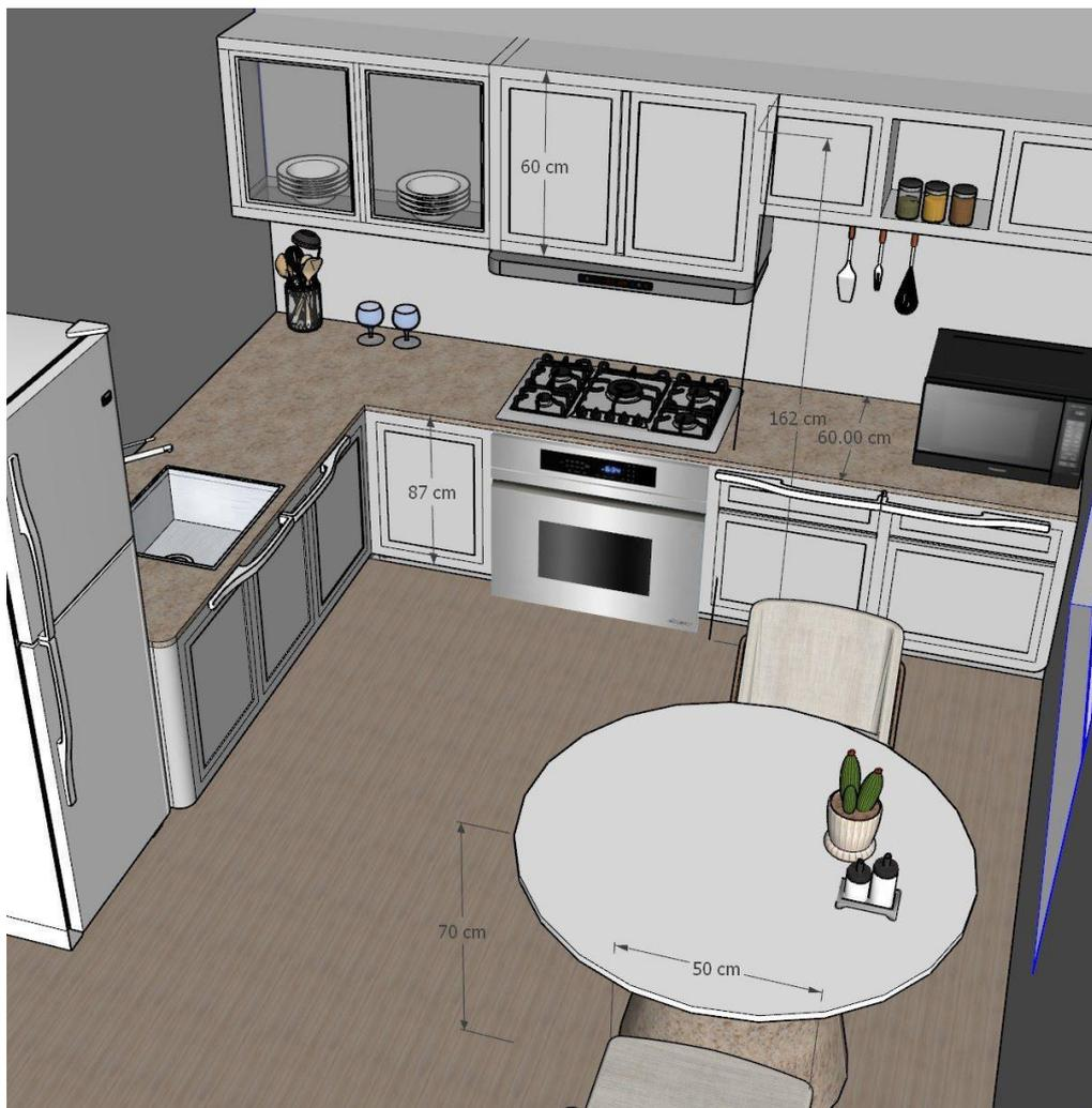
Gambar 2. Desain kabinet berdasarkan data antropometri lansia
