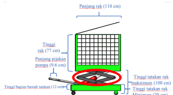
Gambar 2. Keterangan dimensi rak trolley usulan tampak samping
