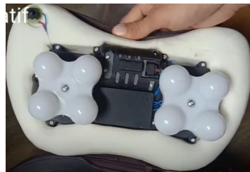
Gambar 5.4 Foam Bantal Pijat Elektrik
