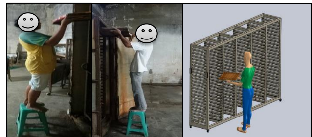
Gambar 16. Perbandingan postur aktual dan usulan pada stasiun pengukusan
