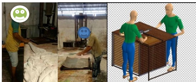
Gambar 15. Perbandingan postur aktual dan usulan pada stasiun penggulungan adonan
