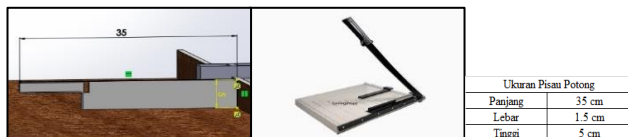
Gambar 4. Pisau memotong adonan pada meja penggulungan
