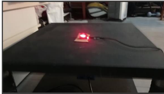
(a) Peletakan sensor di pusat alat sumber gempa
