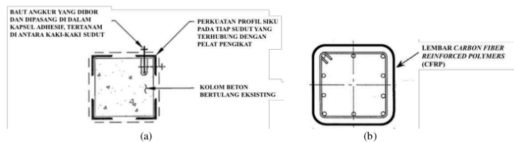
Gambar 1. (a) Potongan perkuatan kolom metode SJ (b) Potongan perkuatan kolom metode penggunaan CFRP
