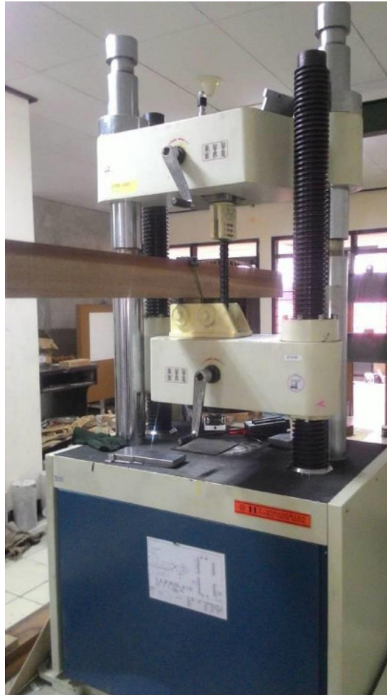
Gambar 5.23 Penyetelan material benda uji kayu solid pada modifikasi UTM
