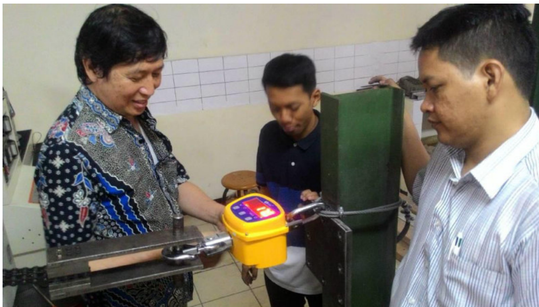
Gambar 5.19 Setting pengujian verifikasi dengan load cell .
