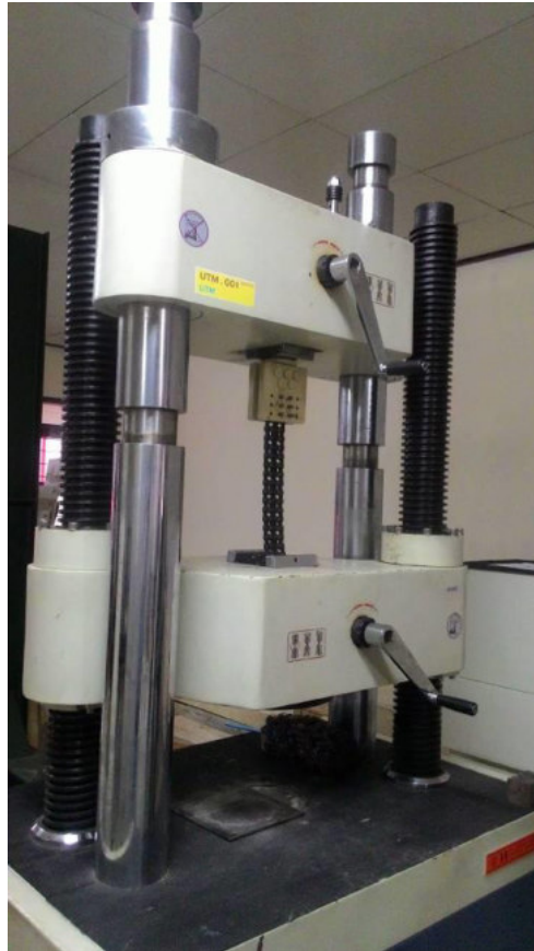
Gambar 5.17 Setting pengujian kalibrasi rantai double
