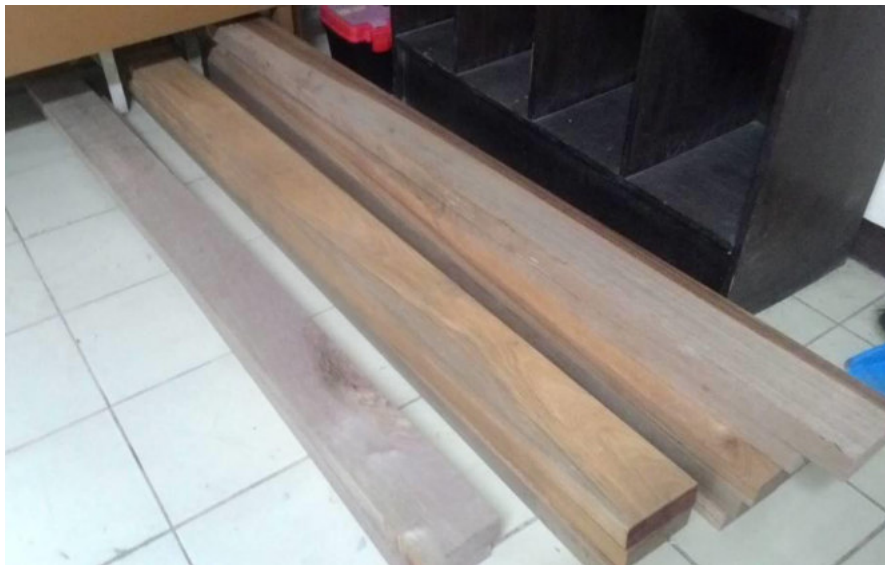
Gambar 5.22 Persiapan material benda uji kayu solid
