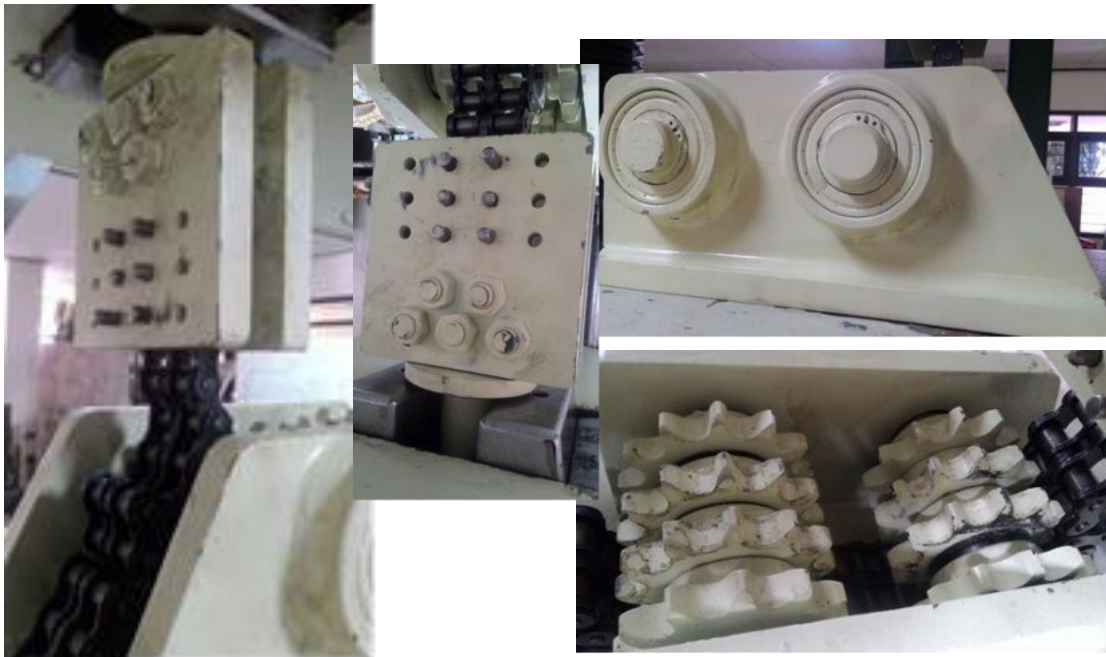
Gambar 5.14 Komponen penjepit dan katrol pada alat inovasi pembalik beban
