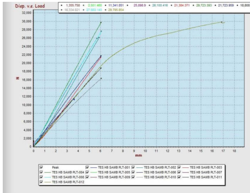
Gambar 5.33 Pengujian balok (L=3 m) dengan sambungan pelat di tengah bentang dengan UTM +
