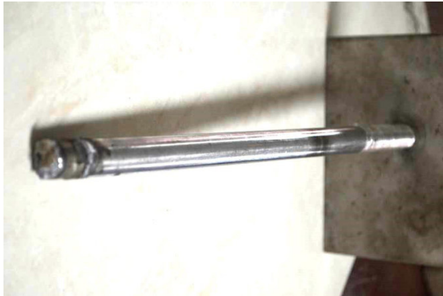
Gambar 5.6 Kerusakan penjepit pada model alat 3
