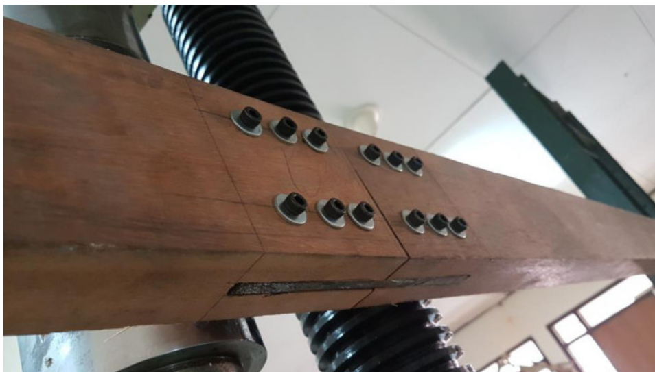
Gambar 5.36 Setting pengujian sambungan balok dengan alat inovasi beban
