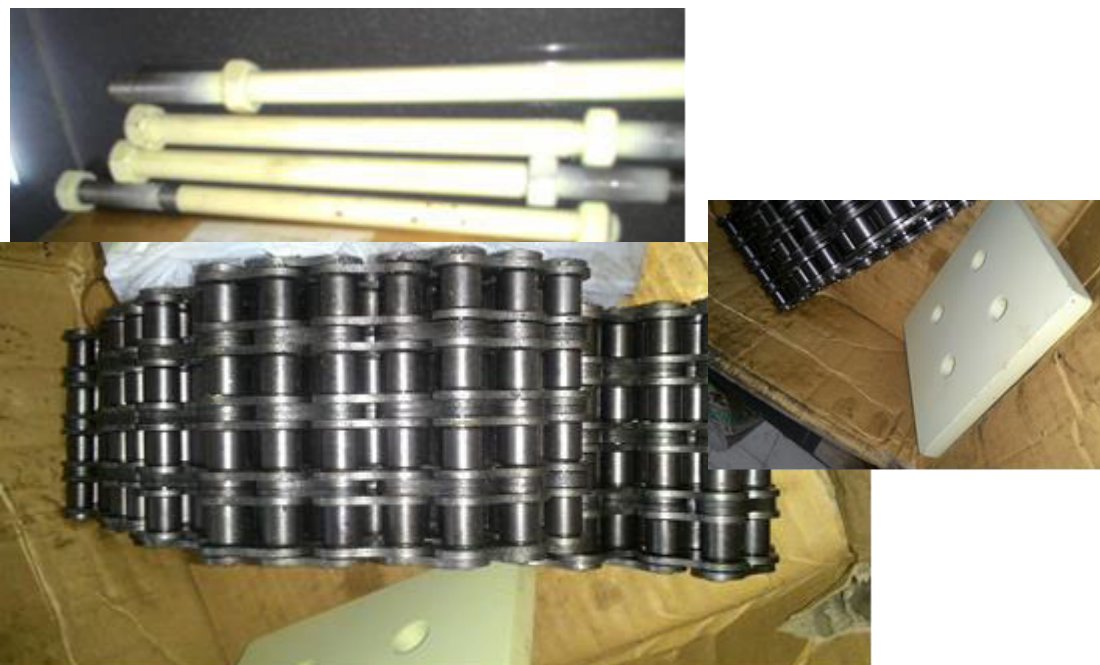
Gambar 5.13 Komponen rantai dan konektor pada alat inovasi pembalik beban
