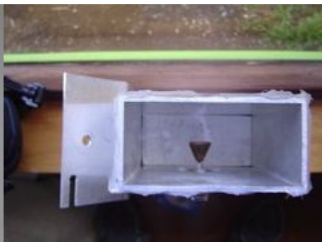
Gambar G.17 Pemasangan N-Soket
