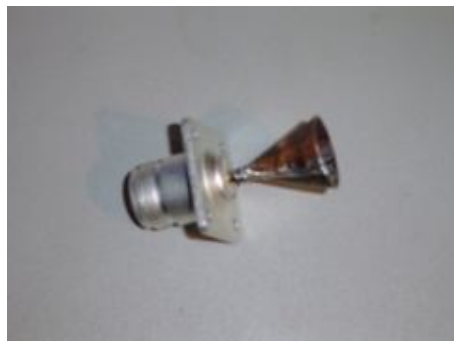
Gambar G.16 Conical Feeder lebih baik Dari pada kawat lurus \frac{1}{4} panjang gelombang
