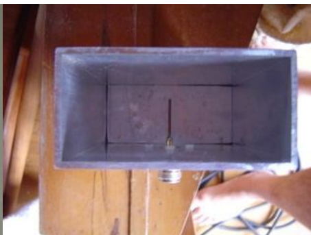
Gambar G.15 Pemasangan N-Soket
