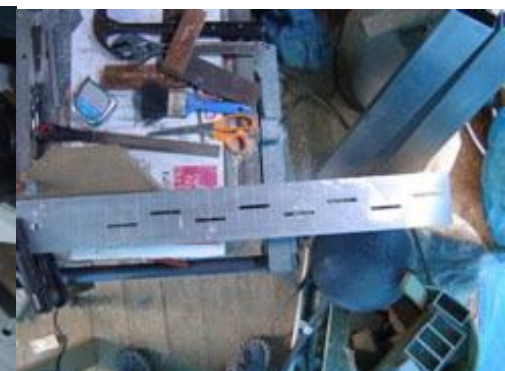
Gambar G.6 Hasil Akhir Setelah Waveguide dilubangi
