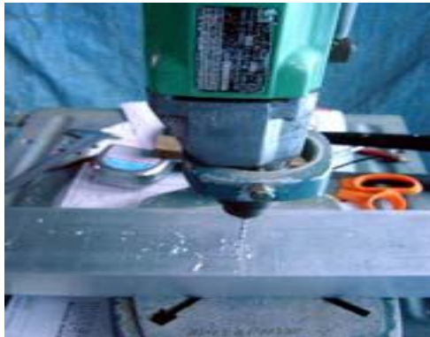
Gambar G.1 Pelubangan dengan Mata Bor 1,00 mm
