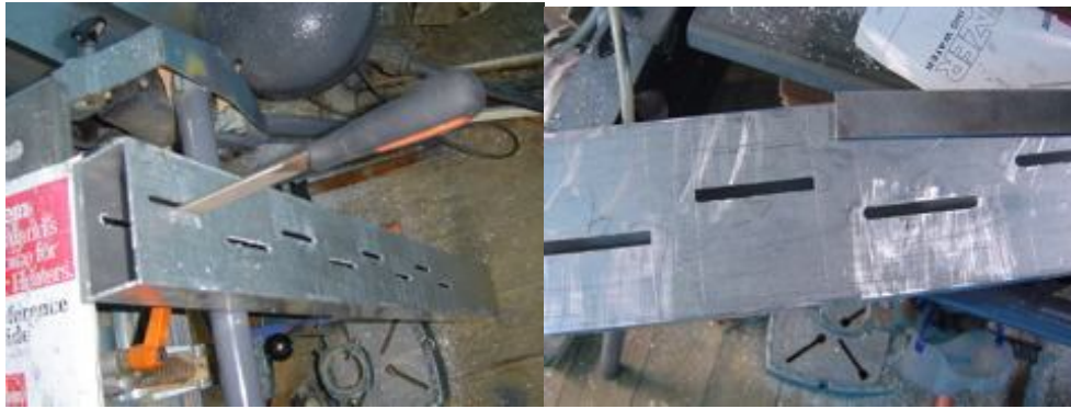
Gambar G.7 Untuk Hasil Akhir Slot dibersihkan dengan Kikir
