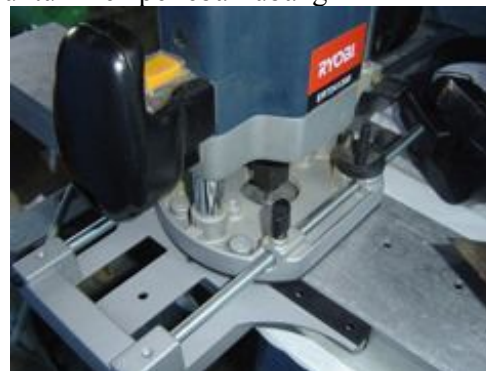
Gambar G.5. Pemotongan Lubang berbentuk slot
