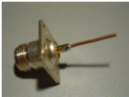
Gambar G.14 Diameter apabila Menggunakan Kawat tembaga 2mm
