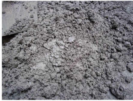
b. Campuran Mortar Setelah Pengadukan
