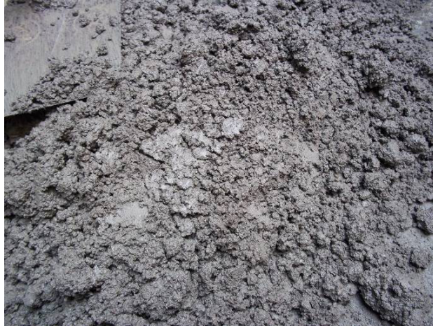
b. Campuran Mortar Setelah Pengadukan
