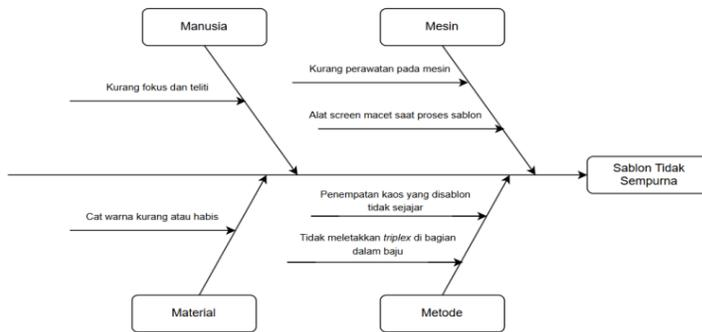
Gambar 5. Diagram Sebab Akibat untuk Screen-Printing Tidak Sempurna
