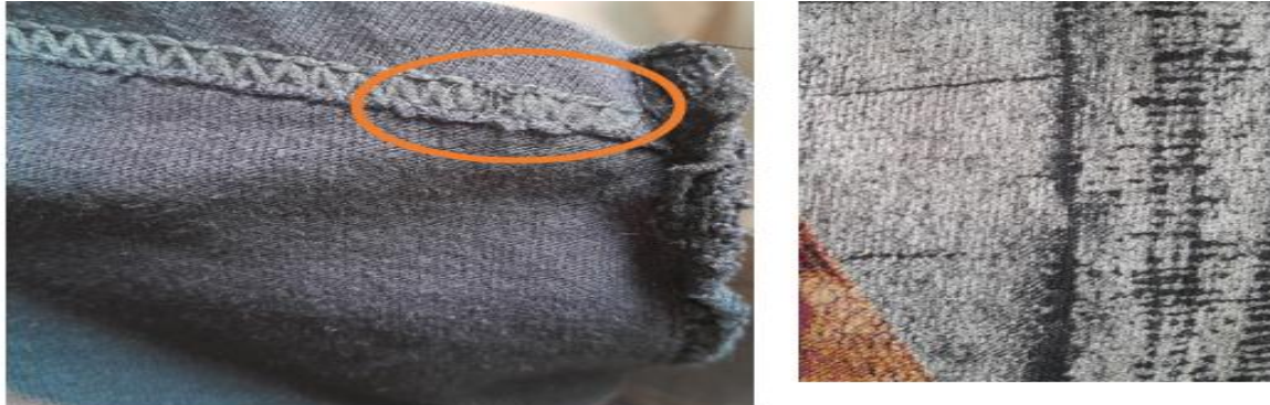
Gambar 1. Jahitan Tidak Rapi dan Screen-Printing Tidak Sempurna
