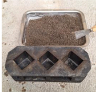
Gambar 2. Bekisting Mortar dan Hasil Adukan
