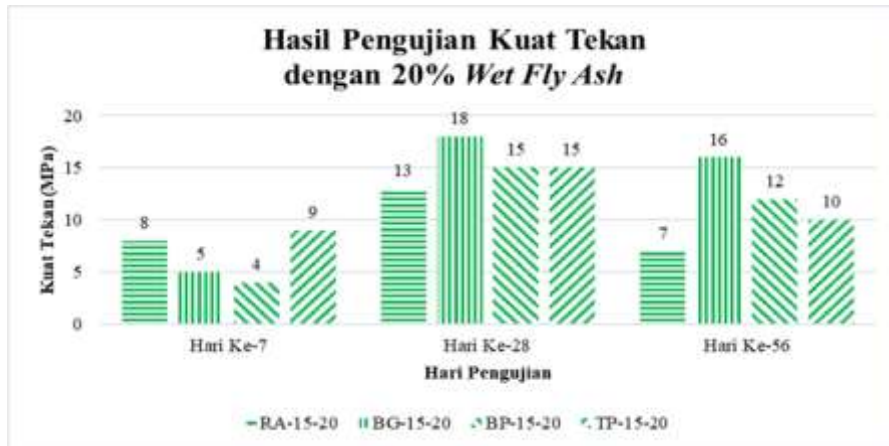
Gambar 9. Perbandingan hasil pengujian kuat tekan benda uji dengan 20% wet fly ash di laboratorium
