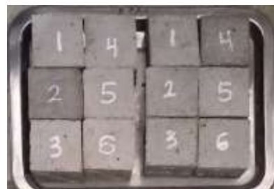
Gambar 5. Metode tanpa perawatan di laboratorium
