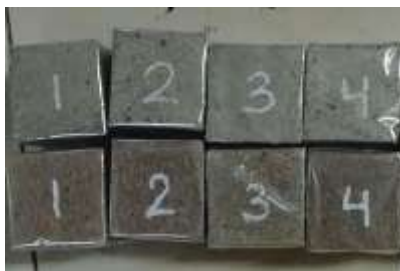
Gambar 4. Metode perawatan bungkus plastik di laboratorium
