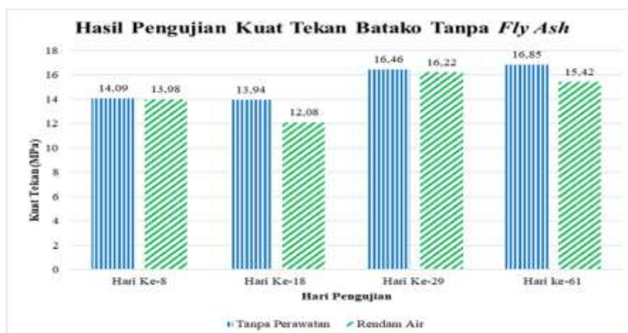
Gambar 10. Perbandingan hasil pengujian kuat tekan batako tanpa fly ash di pabrik
