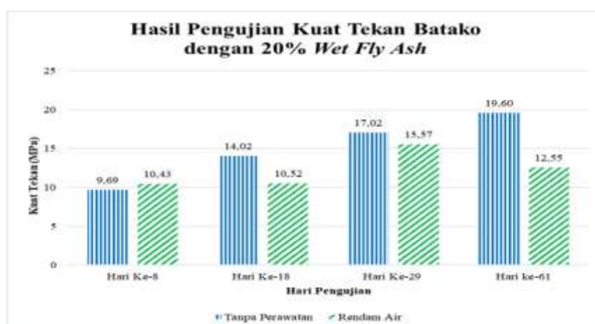
Gambar 11. Perbandingan hasil pengujian kuat tekan batako dengan 20% wet fly ash di pabrik
