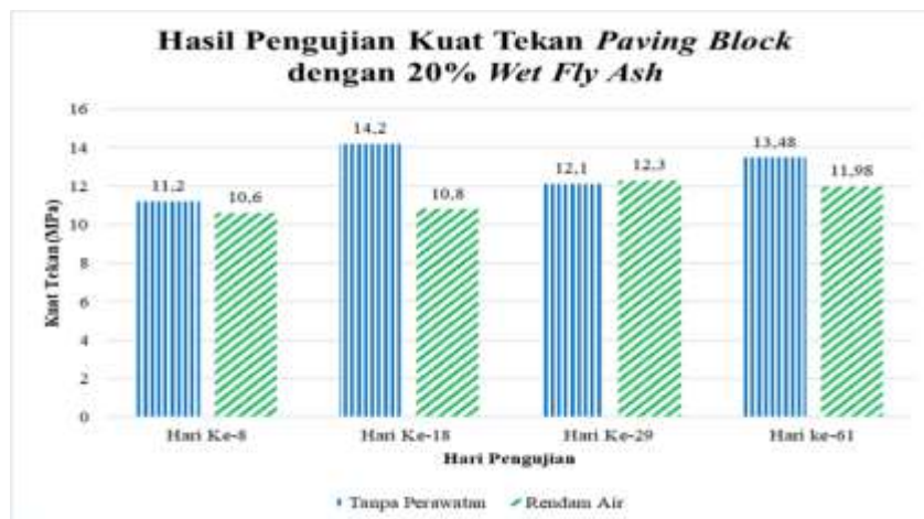
Gambar 13. Perbandingan hasil pengujian kuat tekan paving block dengan 20% wet fly ash di pabrik
