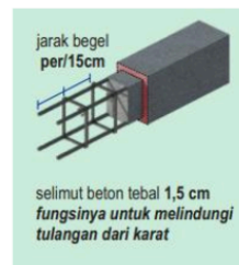
Gambar 10. Jarak Senggang Sloof Sumber: Modul RLH PUPR, 2023
