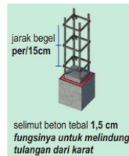
Gambar 15. Jarak Sengkang Kolom Sumber: Modul RLH PUPR, 2023
