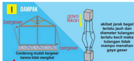
Gambar 18. Dampak Keruntuhan Buckling Sumber: Modul RLH PUPR, 2023
