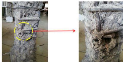
Gambar 28. Hasil Pengujian Kolom K90 Sumber: Kristianto, A. 2015
