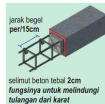
Gambar 21. Jarak Sengkang Balok Sumber: Modul RLH PUPR, 2023
