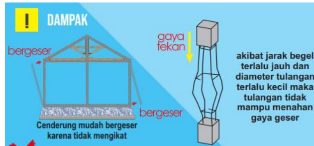
Gambar 18. Dampak Keruntuhan Buckling Sumber: Modul RLH PUPR, 2023
