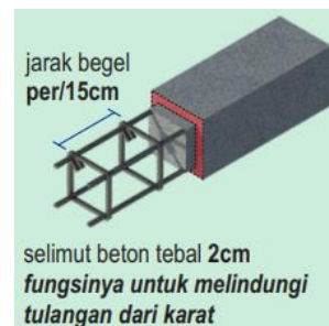
Gambar 21. Jarak Sengkang Balok Sumber: Modul RLH PUPR, 2023
