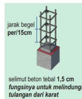
Gambar 15. Jarak Sengkang Kolom Sumber: Modul RLH PUPR, 2023
