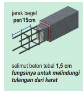
Gambar 10. Jarak Senggang Sloof Sumber: Modul RLH PUPR, 2023
