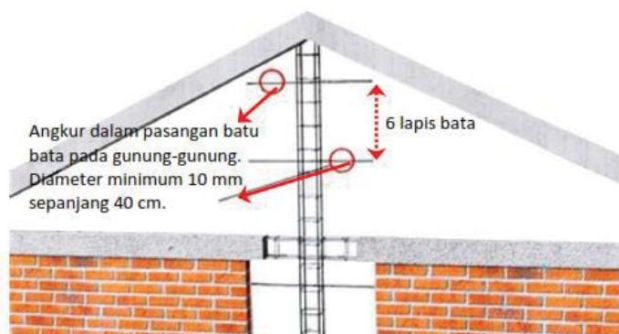
Gambar 8. Hubungan Angkur pada ampig sesuai standar
