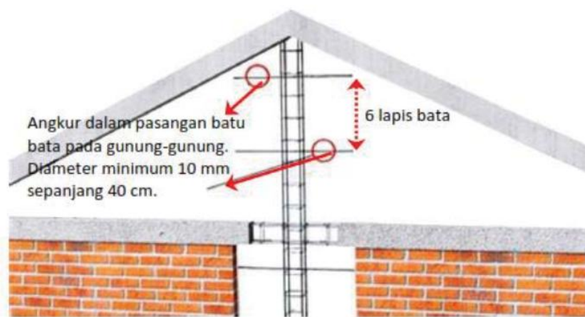
Gambar 8. Hubungan ankur pada ampig sesuai standar
