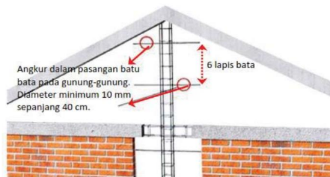
Gambar 8. Hubungan angkur pada ampig sesuai standar
