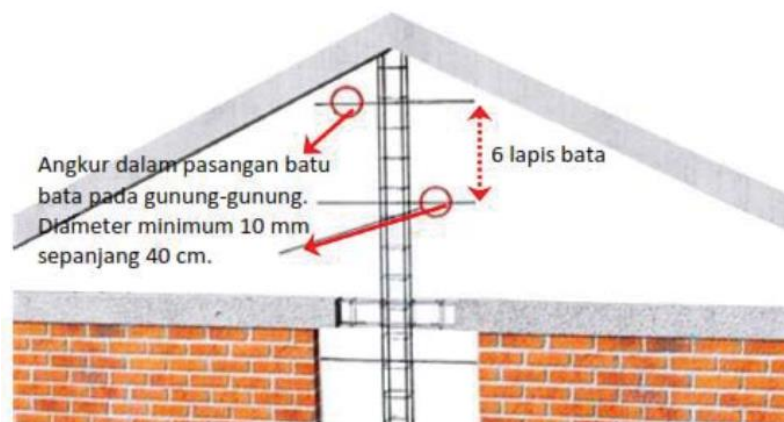
Gambar 8. Hubungan angkur pada ampig sesuai standar
