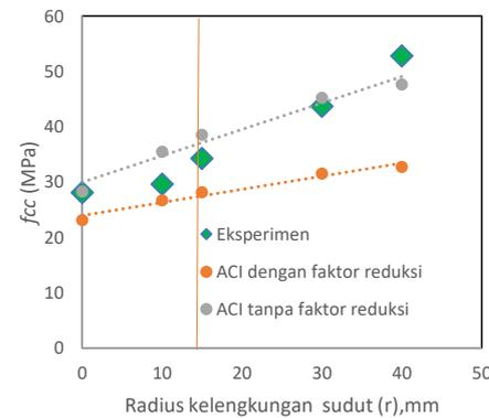
**Gambar 8. Perbandingan kapasitas dengan standar ACI**
