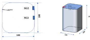
Gambar 2. Gambar benda uji dan penempatan strain gauge
