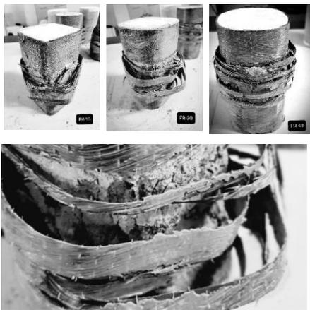
**Gambar 5. Kegagalan pada benda uji dengan radius kelengkungan sudut lebih dari 15mm**
