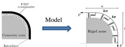
**Gambar 2. Model FRP yang mengekang kolom persegi dengan sudut yang memiliki kelengkungan dimodelkan sebagai spring**
