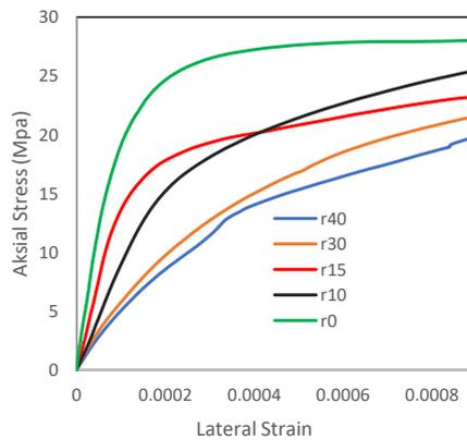
**Gambar 7. Hubungan tegangan dan regangan lateral benda uji**
