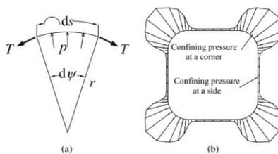
**Gambar 1. Perilaku pengekangan pada sudut penampang persegi: (a) mekanisme gaya tarik; (b) distribusi tegangan pengekangan (Pham, 2014)**
