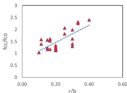
**Gambar 8. Hubungan antara peningkatan kekuatan dengan rasio radius sudut pada beberapa hasil eksperimen**
