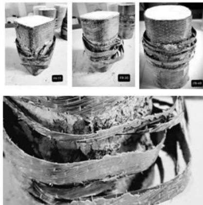
Gambar 6. Kegagalan pada benda uji dengan radius kelengkungan sudut lebih dari 15mm
