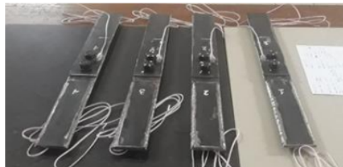
Gambar 12. Pemasangan Strain Gauge Pada Benda Uji
