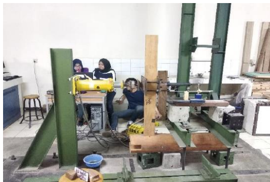
Gambar 2 Benda Uji Sambungan Parsial Balok-Kolom Kayu Sumber: Pranata (2019)
