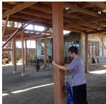
Gambar 1. Uji deteksi tiang/kolom pada bangunan rumah tinggal di kota Manado tahun 2015.
