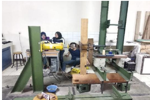
(b). Pengujian sambungan join balok-kolom di laboratorium.
