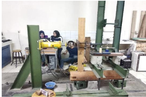
Gambar 4.b. Pengujian sambungan join balok-kolom di laboratorium.
