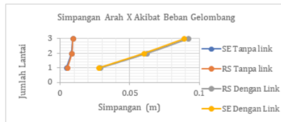
Gambar 7. Grafik simpangan arah-X akibat beban gelombang (Suroso, 2019).
