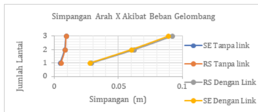
Gambar 7. Grafik simpangan arah-X akibat beban gelombang (Suroso, 2019).
