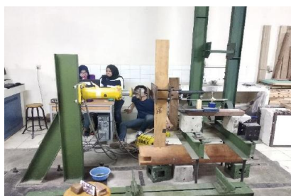
(b). Pengujian sambungan join balok-kolom di laboratorium.
