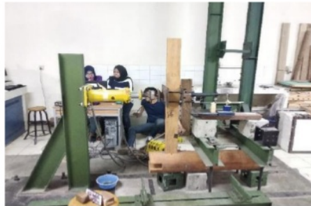
(b). Pengujian sambungan join balok-kolom di laboratorium.
