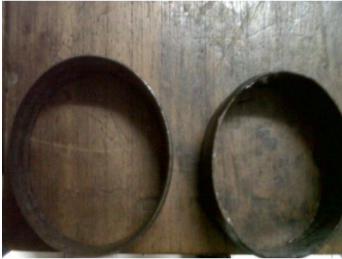
Gambar L4.1 Silinder ring pencetak tanah
