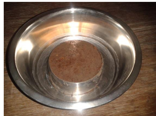
Gambar L4.6 Contoh tanah setelah dicetak pada ring
