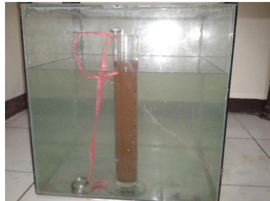
Gambar L2.11 Pembacaan hidrometer dan temperatur pada suspensi dan bak ukur
