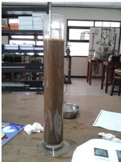
Gambar L2.10 Pembacaan hidrometer dan temperatur pada kondisi suspensi dispersi total
