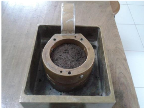
Gambar L7.16 Shear box bagian bawah dan blok pengaku
