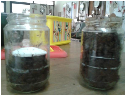
Gambar L6.6 Penyiapan benda uji untuk metode contact
