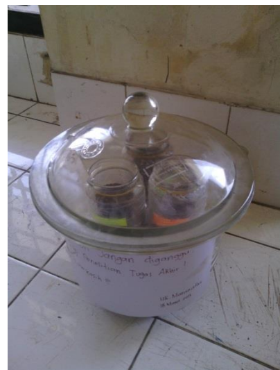
Gambar L6.7 Bahan uji yang sedang didiamkan sampai kondisi keseimbangan dicapai
