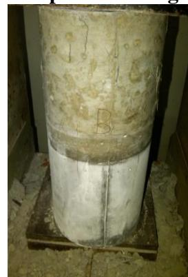
**Gambar L2.17 Beton dengan perawatan air laut setelah diuji untuk kadar kulit kerang 0% umur 7 hari**
