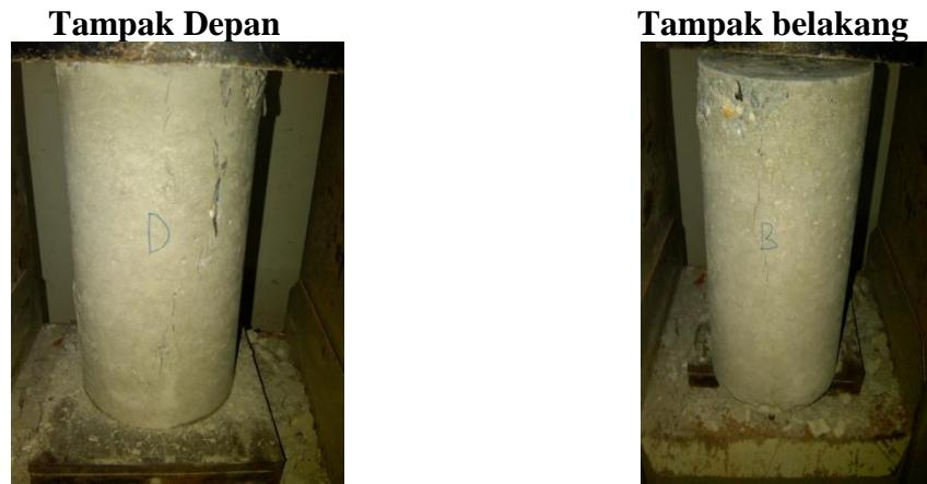
**Gambar L2.14 Beton setelah diuji untuk kadar kulit kerang 20% umur 14 hari**
