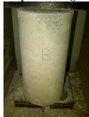
**Gambar L2.6 Beton setelah diuji untuk kadar kulit kerang 10% umur 14 hari**
