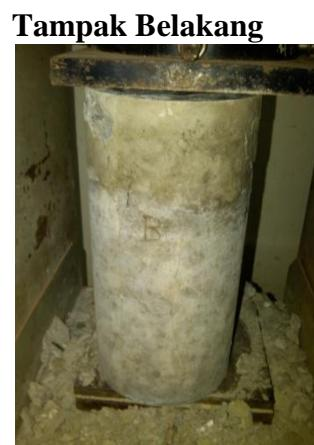
**Gambar L2.22 Beton dengan perawatan air laut setelah diuji untuk kadar kulit kerang 20% umur 14 hari**
