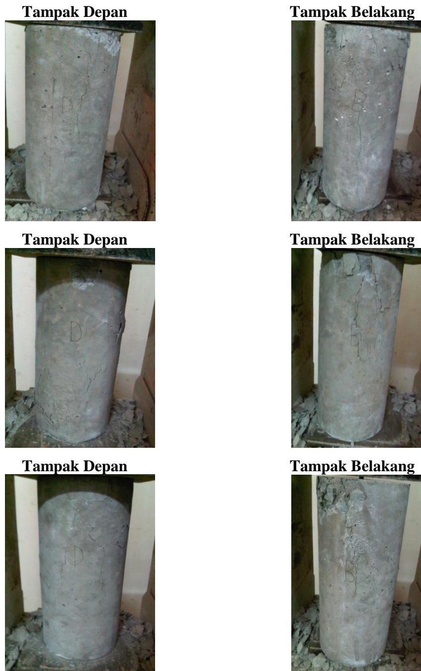
**Gambar L2.19 Beton dengan perawatan air laut setelah diuji untuk kadar kulit kerang 0% umur 21 hari**
