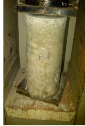
**Gambar L2.12 Beton setelah diuji untuk kadar kulit kerang 15% umur 28 hari**
