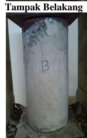
**Gambar L2.9 Beton setelah diuji untuk kadar kulit kerang 15% umur 7 hari**
