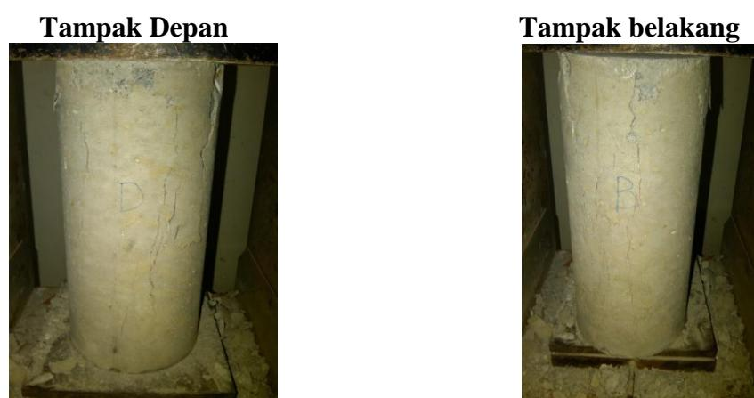
**Gambar L2.15 Beton setelah diuji untuk kadar kulit kerang 20% umur 21 hari**
