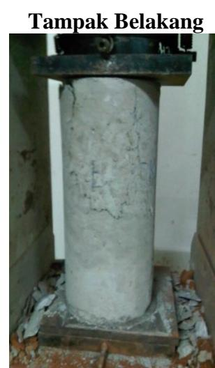
**Gambar L2.5** Beton setelah diuji untuk kadar kulit kerang 10% umur 7 hari
