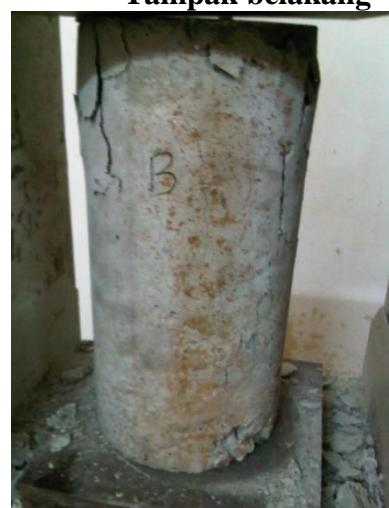
Gambar L2.1 Beton setelah diuji untuk kadar kulit kerang 0% umur 14 hari
