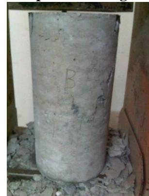
**Gambar L2.24 Beton dengan perawatan air laut setelah diuji untuk kadar kulit kerang 20% umur 28 hari**
