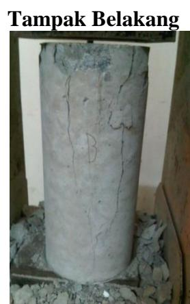
**Gambar L2.20 Beton dengan perawatan air laut setelah diuji untuk kadar kulit kerang 0% umur 28 hari**
