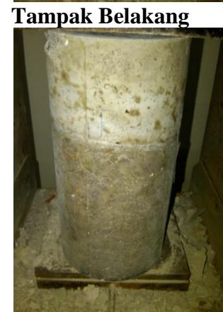
**Gambar L2.21 Beton dengan perawatan air laut setelah diuji untuk kadar kulit kerang 20% umur 7 hari**
