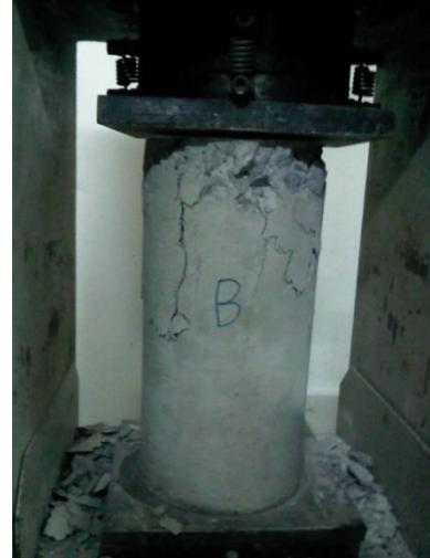
Gambar L2.1 Beton setelah diuji untuk kadar kulit kerang 0% umur 7 hari
