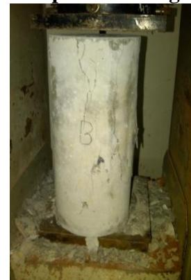
**Gambar L2.16 Beton setelah diuji untuk kadar kulit kerang 20% umur 28 hari**
