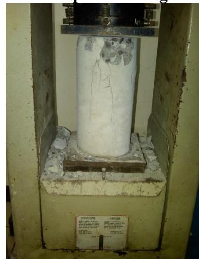
**Gambar L2.1 Beton setelah diuji untuk kadar kulit kerang 0% umur 28 hari**
