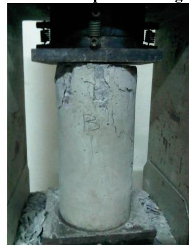
Gambar L2.1 Beton setelah diuji untuk kadar kulit kerang 0% umur 21 hari
