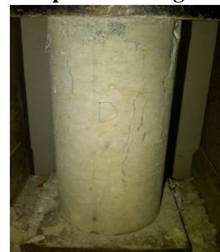
**Gambar L2.23 Beton dengan perawatan air laut setelah diuji untuk kadar kulit kerang 20% umur 21 hari**
