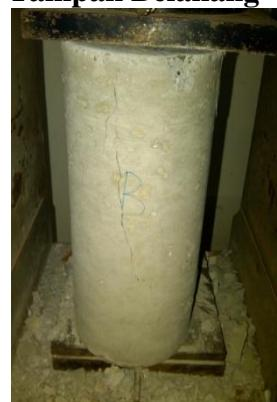
Gambar L2.11 Beton setelah diuji untuk kadar kulit kerang 15% umur 21 hari
