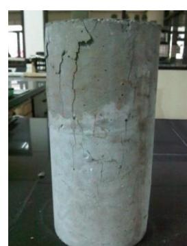
**Gambar L2.17 Beton dengan perawatan air laut setelah diuji untuk kadar kulit kerang 0% umur 14 hari**
