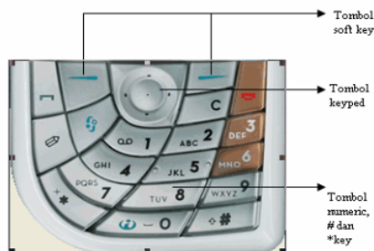
Gambar 2. Tiga macam key yang umum pada handphone
