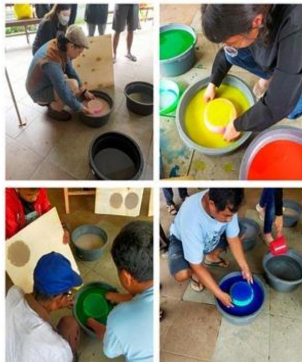
**Gambar 9. Proses menyaring bubur kertas pada baskom**
