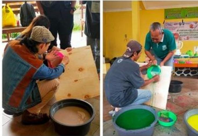
**Gambar 10. Proses mencetak, yaitu menempel bubur kertas pada alas papan triplek**
