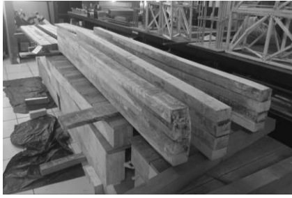
Gambar 9 Proses pembuatan benda uji balok laminasi.
