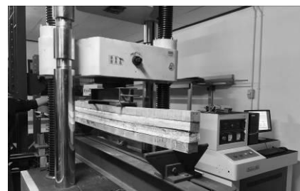
Gambar 10 Proses Pengujian Balok Laminasi Benda Uji.
