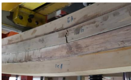
Gambar 12 Ragam kegagalan balok yang terjadi untuk seluruh benda uji yaitu simple tension .
