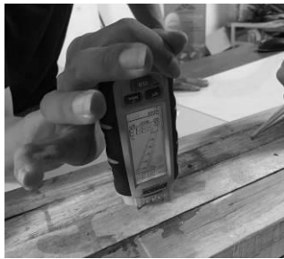
Gambar 7 Proses Pengukuran Kadar Air Pada Lamina Kayu.
