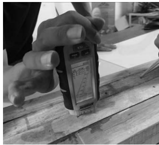
Gambar 7 Proses pengukuran kadar air pada lamina kayu.
