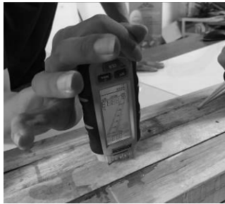
Gambar 7 Proses Pengukuran Kadar Air Pada Lamina Kayu.
