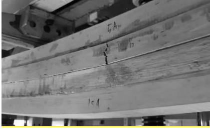
Gambar 11 Ragam Kegagalan Balok yang Terjadi untuk Seluruh Benda Uji yaitu Simple Tension .
