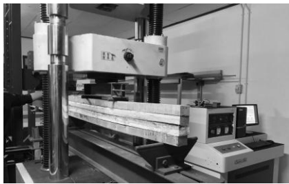
Gambar 11 Proses pengujian balok laminasi benda uji BG-01, BG-02, dan BG-03.
