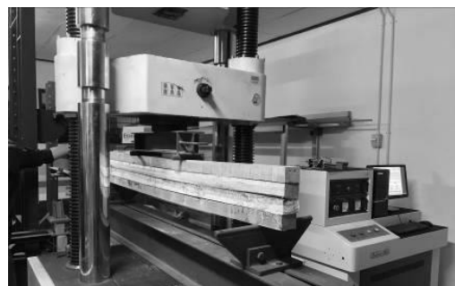
Gambar 10 Proses Pengujian Balok Laminasi Benda Uji.
