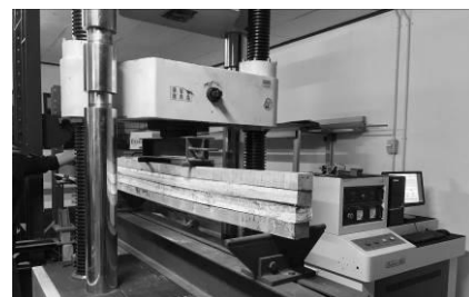
Gambar 10 Proses pengujian balok laminasi benda uji.
