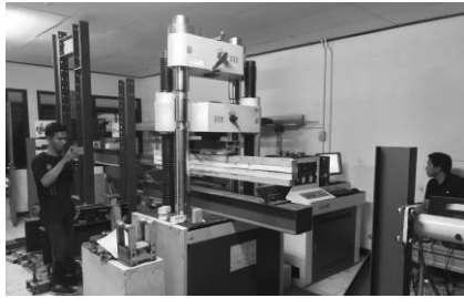
Gambar 10 Proses setup benda uji pada instrument alat uji Universal Testing Machine .
