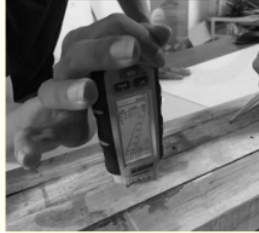
Gambar 7 Proses Pengukuran Kadar Air Pada Lamina Kayu.
