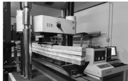
Gambar 10 Proses Pengujian Balok Laminasi Benda Uji.
