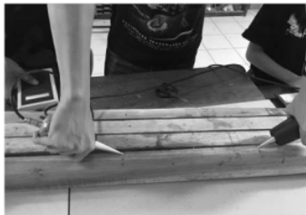
Gambar 8 Proses Pengujian Non-Destruktif untuk Mendapatkan Sifat Mekanika Modulus Elastisitas Dinamik.
