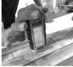
Gambar 7 Proses Pengukuran Kadar Air Pada Lamina Kayu.
