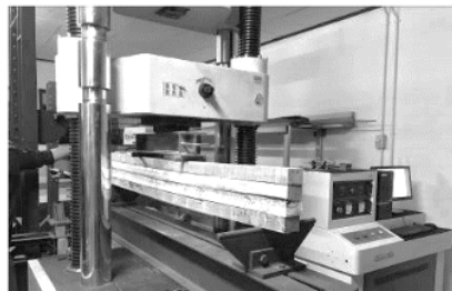
Gambar 10 Proses Pengujian Balok Laminasi Benda Uji.
