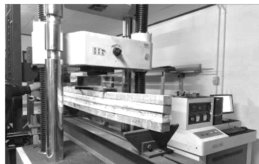
Gambar 10 Proses Pengujian Balok Laminasi Benda Uji.
