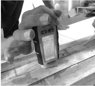
Gambar 7 Proses Pengukuran Kadar Air Pada Lamina Kayu.
